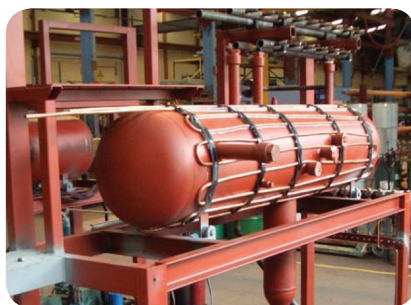
Foto 12 – Exemplo de aplicação da serpentina utilizada para manter o CO 2 “frio” no tanque caso ocorra falha da energia elétrica. A mesma deverá ser conectada a uma unidade condensadora acionada por gerador
