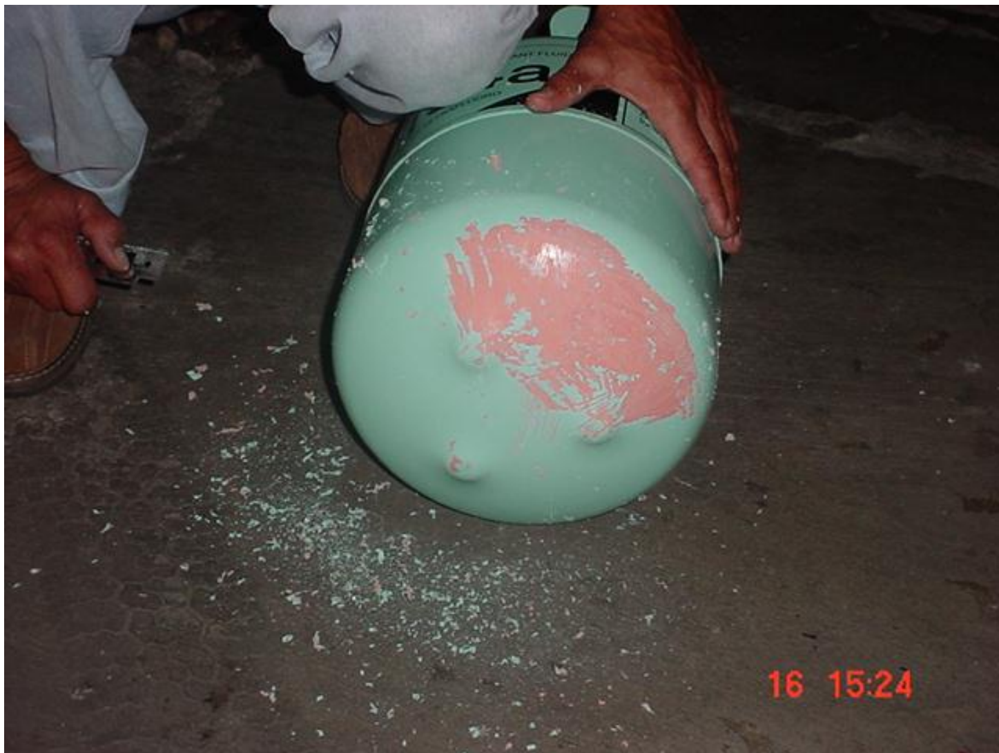
Foto 7: VASILHAME PINTADO DE VERDE, COBRINDO A PINTURA ORIGINAL ROSADA DE VASILHAME DE 13,6 kg DE GÁS HFC-134A.
